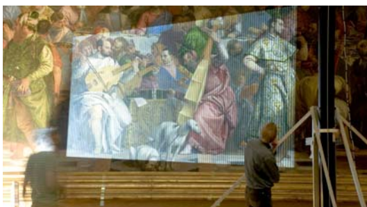
Luce proiettata dal triplo sistema di scansione NUB 3D, utilizzato per registrare la superficie del dipinto di Paolo Veronese
